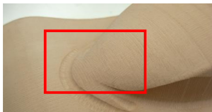
Figura 5. Difetti ottenuti sul pezzo reale
