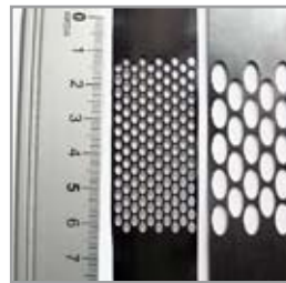
Immagine 3 - Reti in nitinol tagliate con elevate velocità di processo (fino a 3 m/min) utilizzate per alleggerire la struttura del componente mantenendo un elevato smorzamento meccanico.
